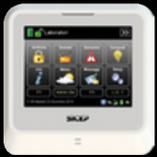
Tastiera Touch-screen a colori 5.7" con lettore di prossimità integrato RFID per centrali UNICA. Consente tutte le principali operazioni di comando. Connessione tramite Bus RS485. Colore bianca.
